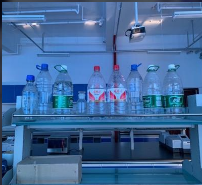
实验室内使用饮料瓶装试剂，未加贴 包含试剂名称/分子式、纯度/浓度， 使用人/负责人、日期等信息的新标签
