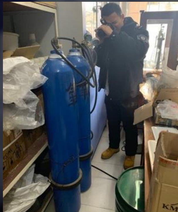
两个氧气瓶采用细绳8字形套在一起
