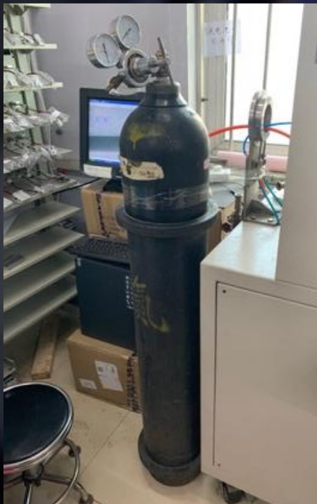
氮气钢瓶采用透明胶带固定
