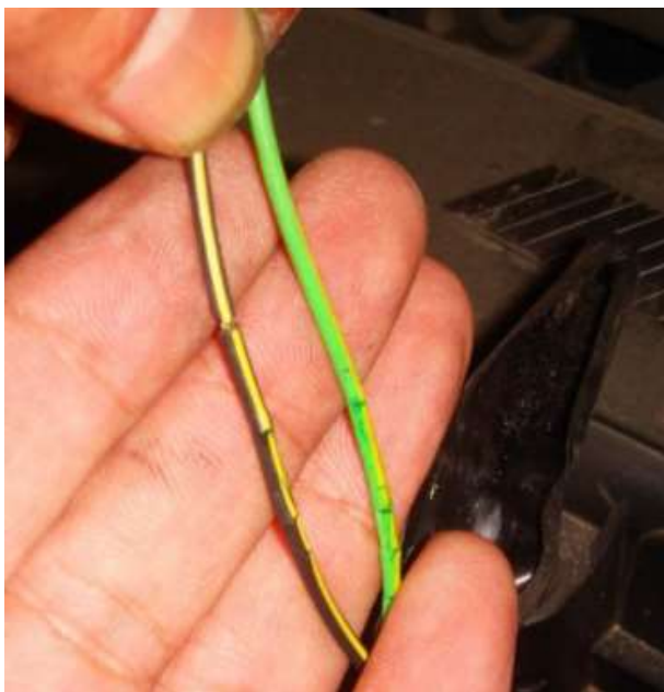
电路老化。特别关注高功率设备，高温设备
