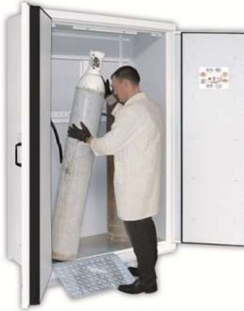
当安全柜外部温度升高或发生火灾时，安全柜密封装置将立刻使安全柜密封，隔热层阻止安全柜内部温度升高，以阻止储气瓶发生额外的风险，延长救援时间
