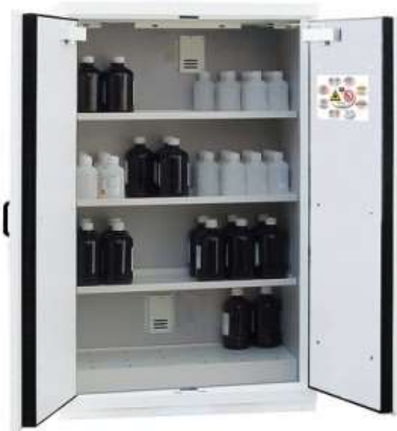
危险化学品存储柜，可连接通风系统，主要用于存放一些闪点低的物质，EN 14470是实验室标准，目前最严格的标准
