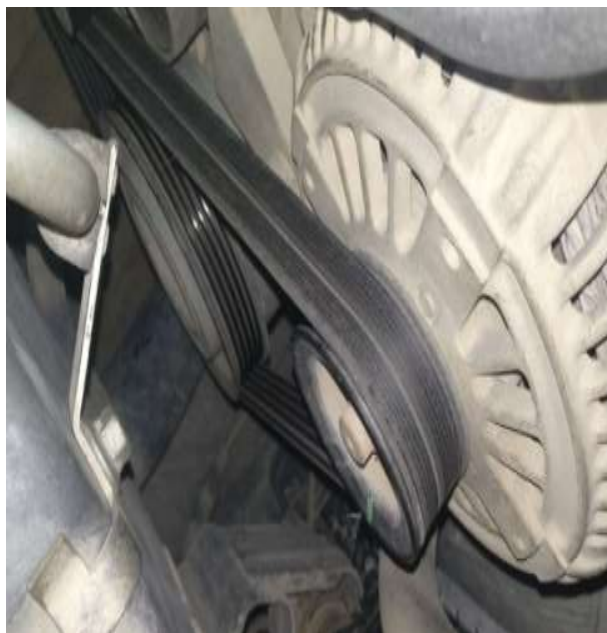
关注机械动转设备，皮带老化
